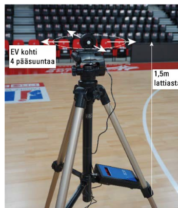
Pystysuuntaisen valaistusvoimakkuuden (EV) mittaaminen
