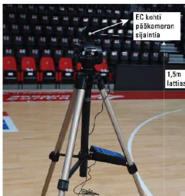
Pääkameran valaistusvoimakkuuden (EC) mittaaminen
